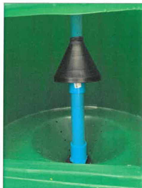
ท่ออากาศภายในถัง สำหรับให้อากาศแก่ จุลินทรีย์ใช้สำหรับย่อยขยะอินทรีย์
